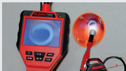
Inspection de conduites diamètre tubes > Ø 14 mm
