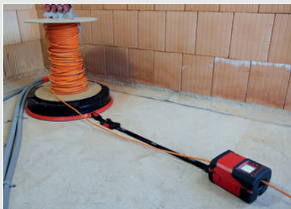
RM35 avec sangle et système d'attache fixé sur XB 500
